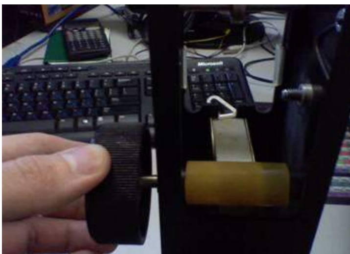
Рис. 8. Прототип конвейерного фото-/денситометрического калибровочного устройства для считывания плекс-лент чипов: а – общий вид; б – узел вращения каретки / носителя
