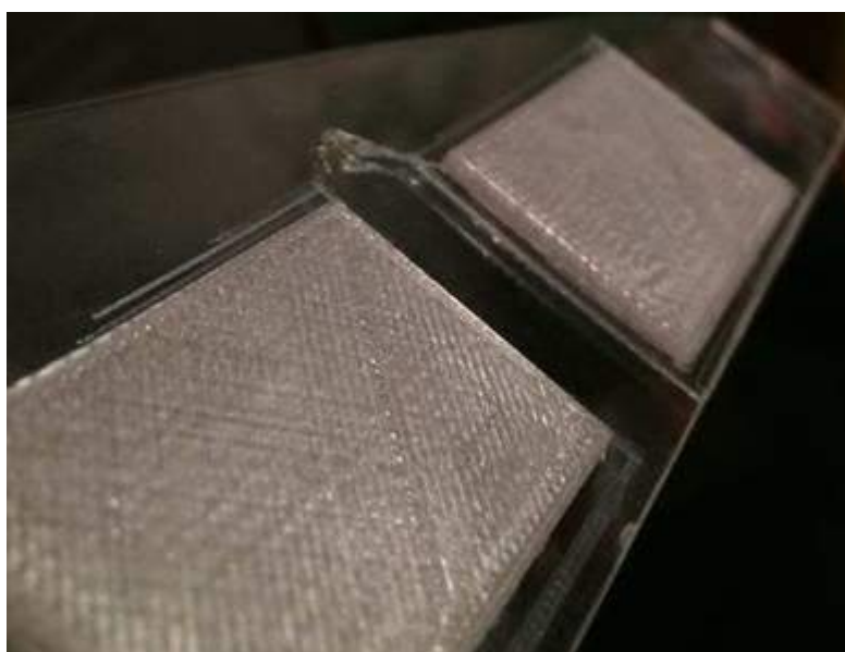
Рис. 7. Мезофлюидные многоячейстые полимерные чипы-прототипы на «конвейерной ленте» из акриловой смолы – полиметилметакрилата. Гнущаяся плекс-лента может быть изготовлена из данного состава любой трейд-марки (лимакрил, плазкрил, акрилекс, акрилайт, акрипласт, метаплекс, люцит, акрилит, перспекс, новаттро, плексима и т.д.)
