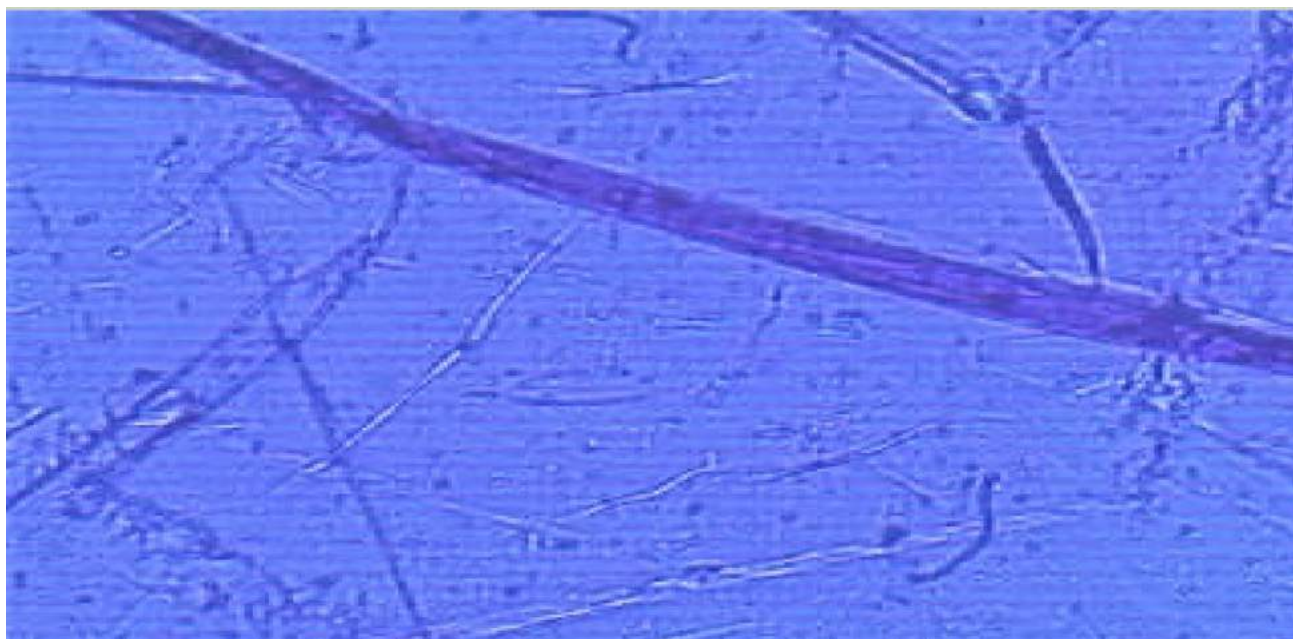
Рис. 22. Непосредственная прямая регистрограмма с чипа как безлинзового микроскопа в коротковолновом диапазоне (спектрозональный В-канал). Видны элементы микроструктур (фибрилярного и филаментарного характера). Использован стандартный чип и передача по кабелю через универсальную серийную шину (разработка модификации 2016-2017 гг.)
