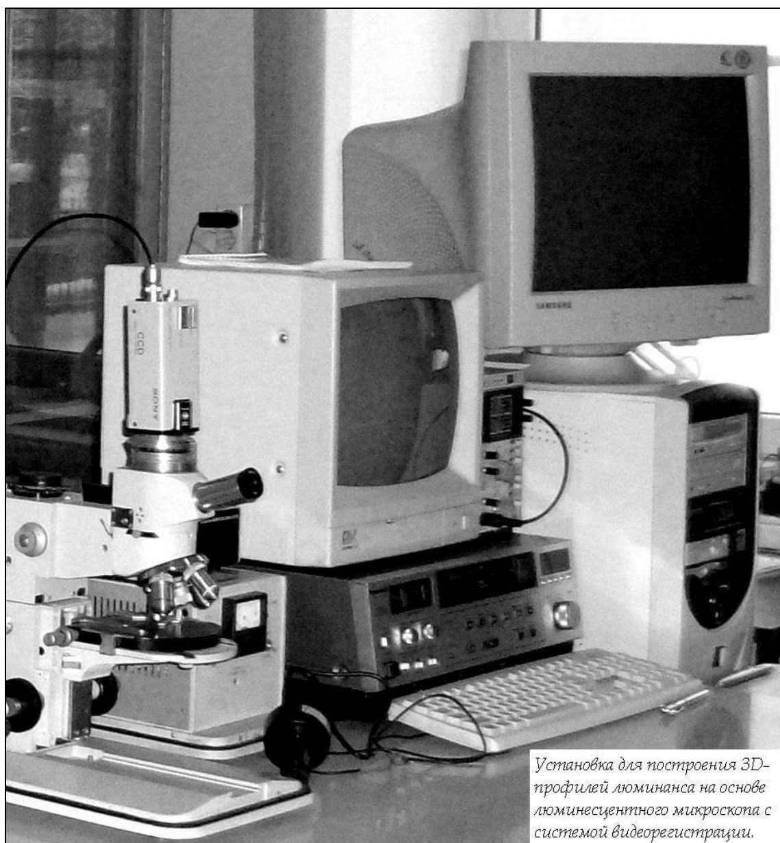
Рис. 17. Установка панорамного подсчета частиц с осциллографической регистрацией при видеомикроскопии на базе микроскопа люминесцентного дорожного ( ГЕОХИ РАН, 2011 )
