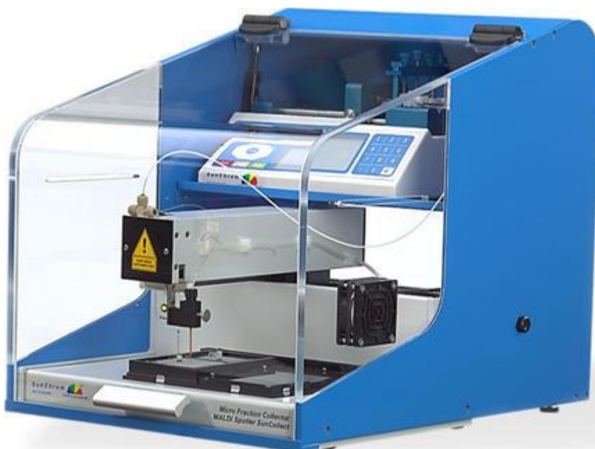
Рис. 15а. Программно-аппаратный комплекс для программируемого нанесения проб для MALDI-имэджинга (SunCollect Systems – с сайта CHEMEUROPE.COM)
