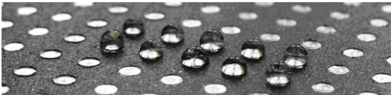
Рис. 6. Почти «идеальное» состояние капель после нанесения на мишень (anchor chip) при оптимальной гидрофобности поверхности и допустимой ошибке ручного дозирования. При ручном дозировании ошибка может достигать десятков процентов от объема капли
