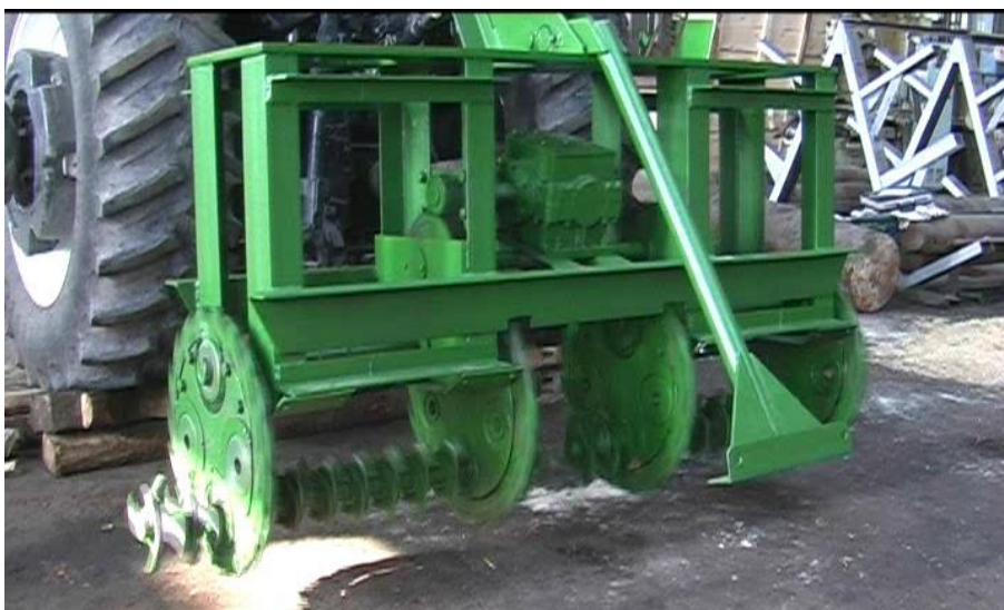
Рис. 10. Внутрипочвенный фрезерный рыхлитель с роторным приводом ПМС-280. 2008 г.
