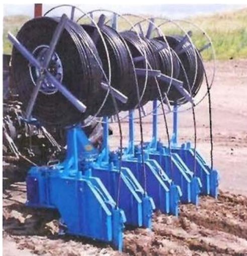
Рис. 2. Капельный внутрипочвенный полив
