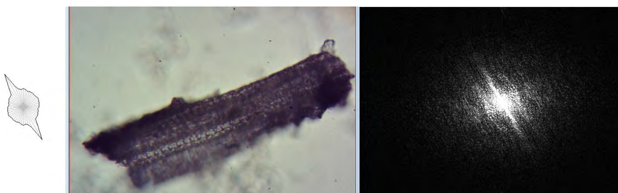
Рис. 5. Корни хрена (измерение в капле, 400×). Положительный результат попытки разрешить клеточную структуру и увидеть тонкие элементы модуляции двумерного БПФ (2D FFT), обусловленные ею, путем увеличения переходом на более высокоразрешающий объектив в револьверной турели микроскопа
