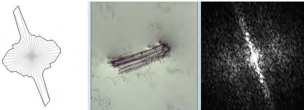
Рис. 6. При разрешении клеточной структуры образца, работающей как дифракционная решетка, формируется модуляция исходного пика рассеяния
