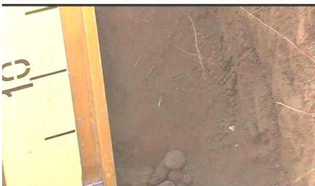
Рис. 9. Почва после фрезерного рыхления слоя 20–45 см, глубина 40–45 см
